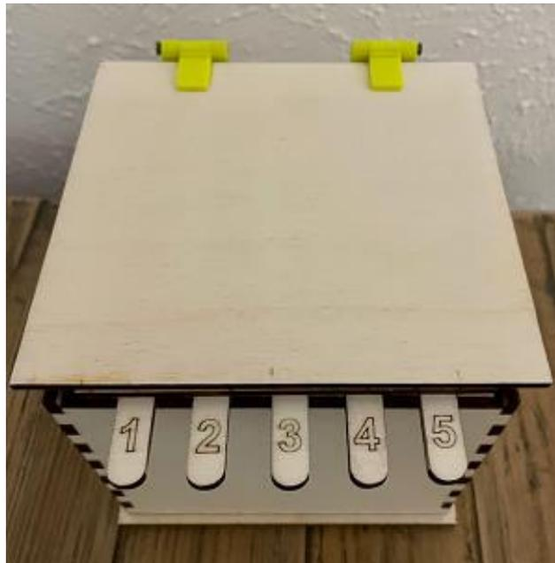
Funktion: Durch ziehen der richtigen Stäbchen 1-5 wird der Safe entriegelt und der Safe lässt sich öffnen.
